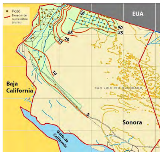
Figura 11. Batería de pozos (puntos) de la Mesa Arenosa, San Luis Río Colorado, Sonora. con profundidad al nivel estático (m)
